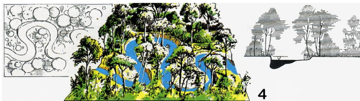
Obr.8.1 Schéma postupného vývoja rieky od napriameného k prirodzenému riečnemu korytu (meandrujúceho typu) po odstránení brehového opevnia a uvoľnení laterálneho vývoja (Binder et al, 2015)
