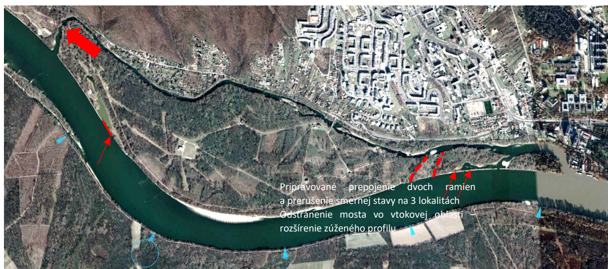
Obr. D.7 Karloveské rameno – zásahy plánované k realizácii: odstránenie mosta – zväčšenie mostného profilu, prerušenie líniovej smernej stavby v troch lokalitách, prepojenie dvoch priečných ramien
