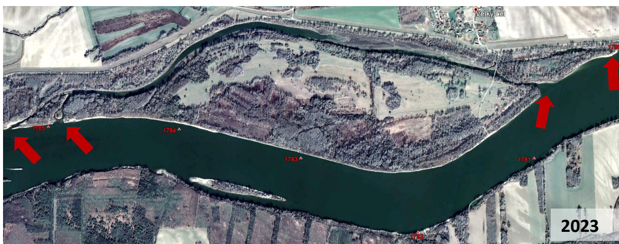
Obr. D.11 Velkolélsky ostrov – sprietočnené dve ramená na vtoku a dve vetvy výtoku, vybudovanie mosta cez rameno – odstránenie bariéry – realizovala BROZ
