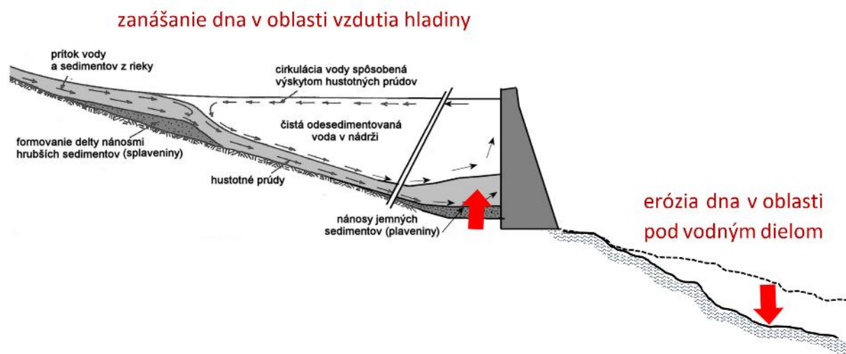
Obr. 11.1 Schéma procesov sedimentácie a erózie v oblasti priečnej bariéry na toku (prerušenie pozdĺžnej kontinuity transportu sedimentov)
