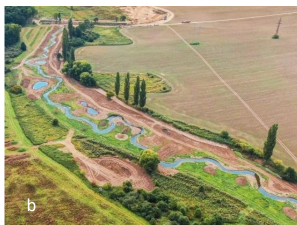
Obr.C.7 Príklady premeandrovania napriamenej upraveného koryta s priestorovým obmedzením a) rieka Skerne v urbanizovanom priestore, Anglicko, b) rieka v poľnohospodársky využívannej krajine-Česká republika
