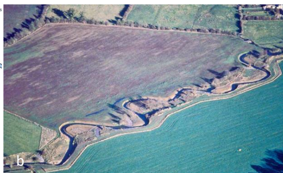
Obr.C.3 Revitalizácia rieky Cole (UK): vytvorenie nového meandrujúceho koryta menšej kapacity, ktoré zároveň umožňuje častejšie zaplavovanie inundačného územia a) schéma revitalizácie, b) pohľad na premeandrované koryto po realizácii (1996)
