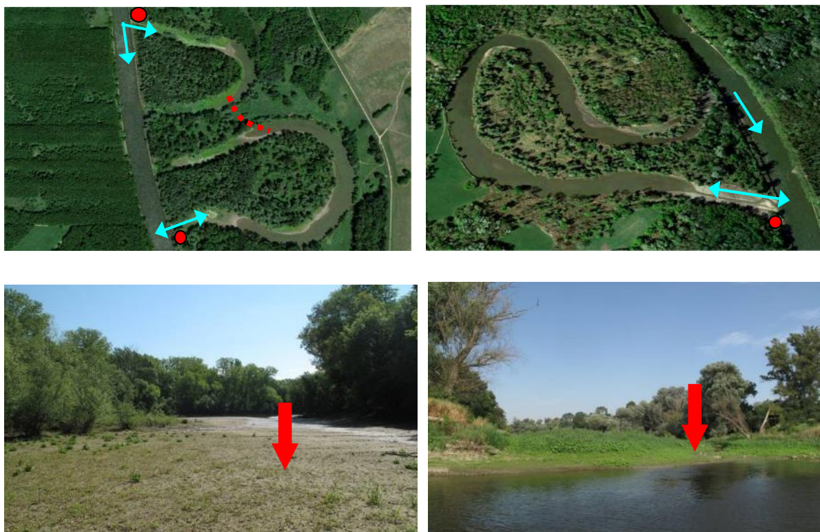
Obr. F.1 Neúspešné pokusy o sprietočnenie meandrov Moravy na slovenskej (obojsstranné) i rakúskej strane (spodná vetva) obdobie 1998 až 2006 – na fotkách situácia v období po 5 rokoch
