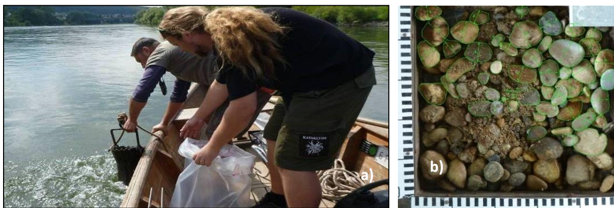
Obr.5.11 Odbery dnových sedimentov (a) odber pod hladinou – odberákom VÚVH, b) odber z riečnej lavice
